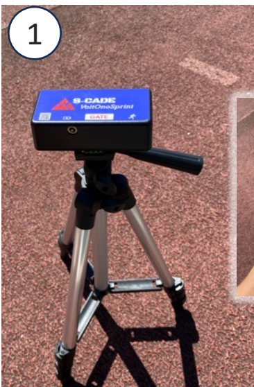
光電管を三脚に設置します
