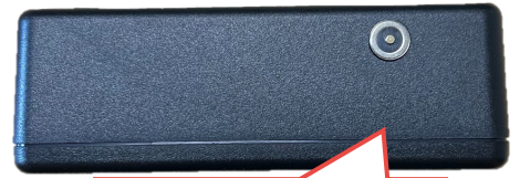
電源供給部分
