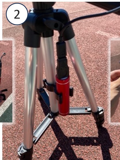
バッテリーを三脚に結合させます
